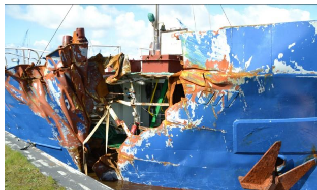
Fig. 1b. Le cargo Petra L. est entré en collision avec une éolienne offshore du parc Gode Wind 1 (Allemagne).
